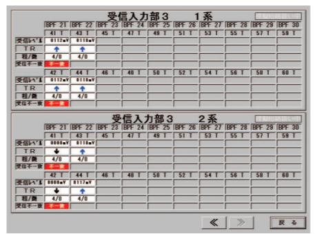
列車検知信号の位相を意識しない信号方式に統一し、軌道回路の調整を容易にするとともに、架内に液晶パネルを設け、各部の稼動状況(正常/異常)や故障情報及びレベル等の確認を容易にしました。
