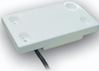
ATS-P(N)システムは、東日本旅客鉄道殿及び西日本旅客鉄道殿の主要幹線で使用されている保安度の高い運転保安システムであるATS-Pシステムのコストダウンを目的として開発されました。東日本旅客鉄道株式会社安全研究所殿（現:JR東日本研究開発センター殿）と共同開発した当社のATS-P(N)地上子は、車上子と結合時に全設定電文を照査し、異常を検知した際には、電文送信を停止する故障検知機能が追加されています。
