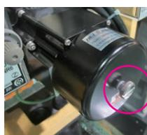
停電時には補助ブレーキが作動、その場停止が可能です。
